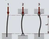
На диаграмме, в соответствии с вариантом заделки концов винта (1/2/3), определяем точку пересечения частоты вращения и длины винта  $L$ . Точка пересечения должна лежать ниже границы выбранного диаметра винта. Если это условие не выполняется, то необходимо выбрать больший диаметр винта или следующий типоразмер редуктора.
