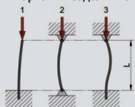
На диаграмме, в соответствии с вариантом заделки концов винта (1/2/3), определяем точку пересечения силы  $F$  и длины винта  $L$ . Точка пересечения должна лежать ниже границы выбранного диаметра винта. Если это условие не выполняется, то необходимо выбрать больший диаметр винта или следующий типоразмер редуктора.
